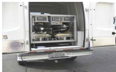
<미국 신재생에너지연구소의 수소 충전기 현장시험장치>
