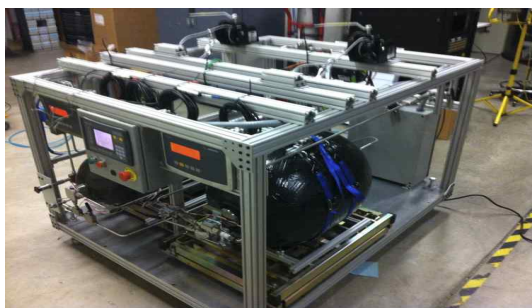
<미국 신재생에너지연구소의 수소 충전기 현장시험장치>
