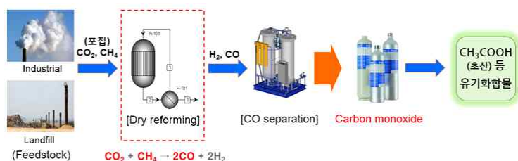
[그림 7] CO 2 전환 일산화탄소 등 제조 공정 모식도
